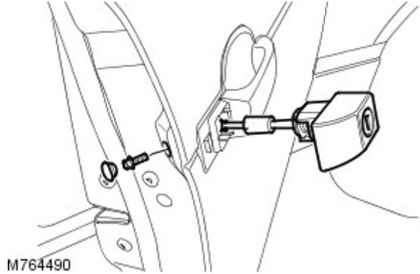
5. 卸下固定门锁的螺钉并卸下门锁总成。
